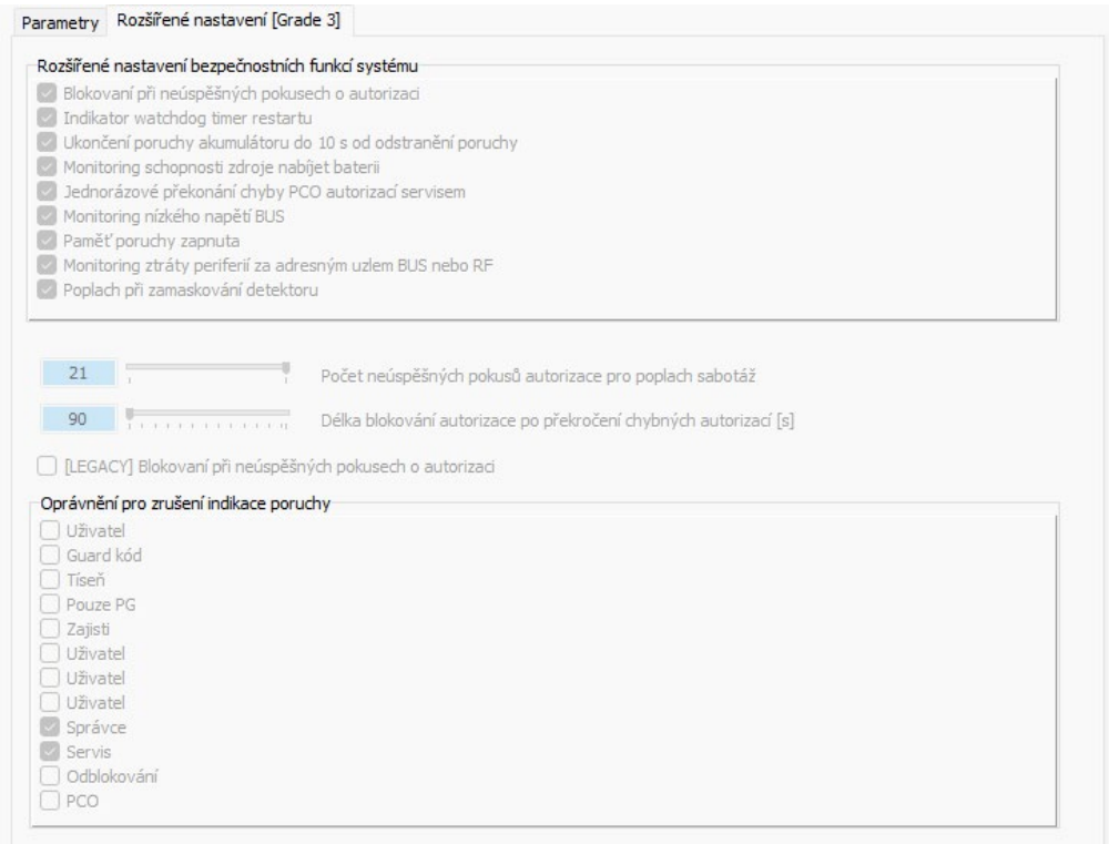
Obrázok 51 - Parametre - Úroveň zabezpečenia (F-Link)
